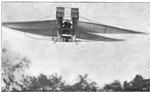
Apparat Nr. 4 a mit 3 P. S. Motor, ca. 11 m hoch.
